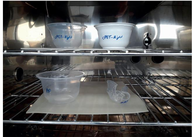
**Bild 5.** Vergleich der geprüften Muster vor und nach 30 Minuten Ofentest bei 100 °C © Illig
